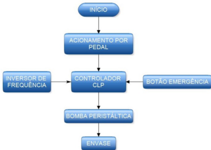
Figura 8: Diagrama de instalação e controle.
