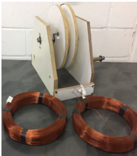
Figura 5: Módulo enrolador de bobinas.
