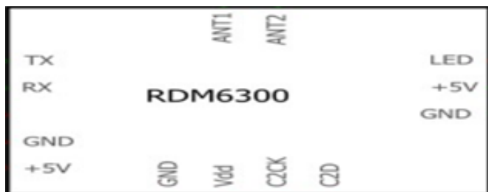
Figura 13: Pinagem do módulo leitor RFID RDM6300.
